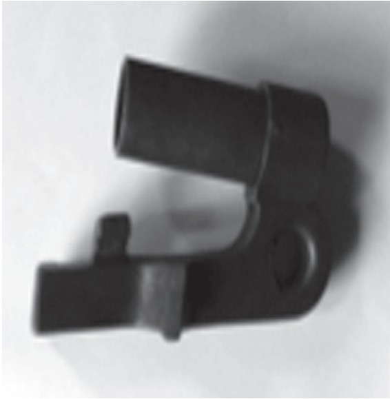
■ สลักล็อกใบจักรตอร์ปิโดแบบ ๔๕ น ที่ญี่ปุ่นออกแบบมาให้ความสะดวกในการใช้และกันลี้มถอดตอนยิง
