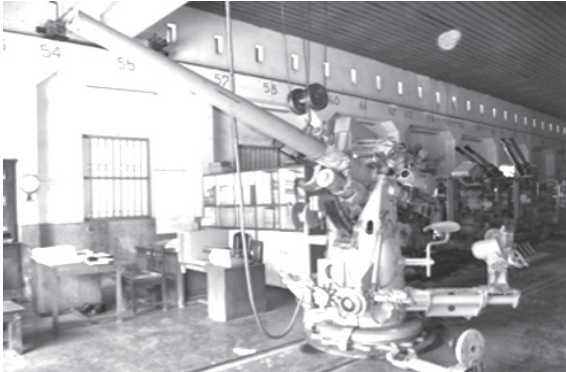
■ ปีนใหญ่ ๗๖/๕๐ มม. แบบอเมริกันจะเห็นถึงโครงสร้างที่มีขนาดใหญ่ ทำให้น้ำหนักเพิ่มขึ้นมาก
