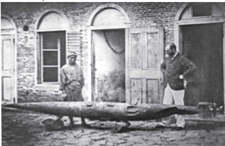
■ ภาพตอร์ปิโดแบบของนาย Whitehead ที่ทำการทดสอบในปี ค.ศ.๑๘๗๕
