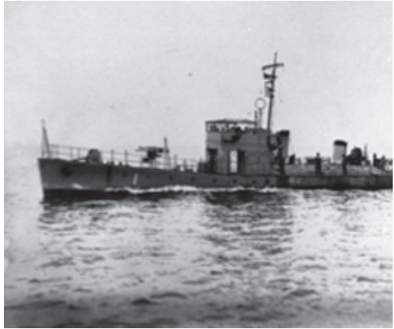
■ เรือตอร์ปิโดเล็กที่ใช้ประโยชน์ในการฝึกและทำการได้อย่างประหยัดมีอาวุธแตกต่างคือเพียงปืนใหญ่หัวเรือเป็นปืน ๗๖/๒๕ มิลลิเมตรขนาดกะทัดรัดเหมาะสมกับขนาดเรือ และเป็นความชาญฉลาดในการเลือกและจัดหาอาวุธมาตรฐานใช้กันทั้งเรือตอร์ปิโดใหญ่ เรือตอร์ปิโดเล็ก และเรือดำน้ำ
